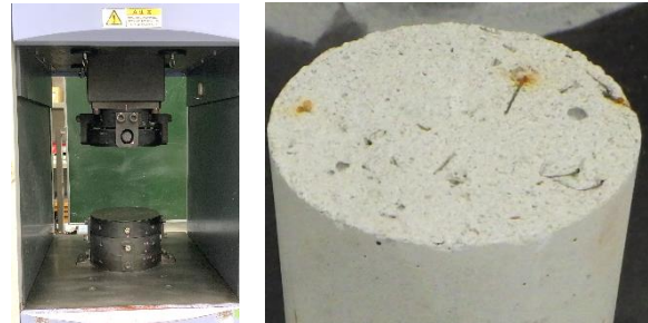
写真-3 圧縮試験機（左）と供試体端面（右）の写真
