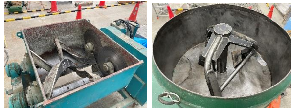
写真-1 使用ミキサ（左：シャフトレスミキサ，右：大型のパン型強制練りミキサ）
