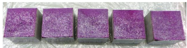
写真-4 促進中性化試験結果
