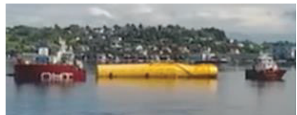
写真-1 スパーク型浮体曳航時の様子
