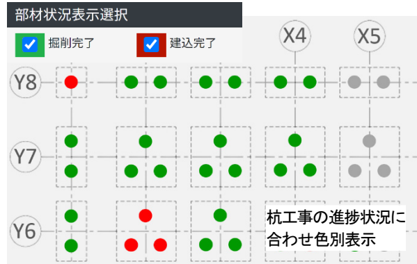
図-9 杭打設の 2D 進捗管理画面
