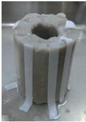
写真 3 試験後の状態（供試体17（濃度8%））
