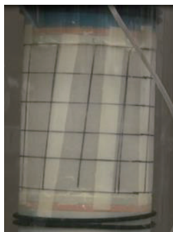
写真 2 繰返し中空ねじりせん断試験状況 (供試体 11 (濃度 6%))
