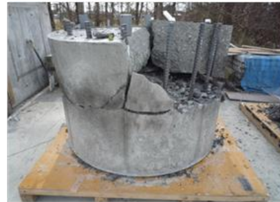
写真-13 破砕直後:試験体3
