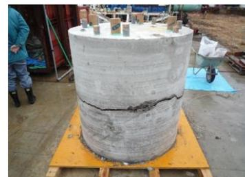
写真-12 破碎直後: 試験体2-3
