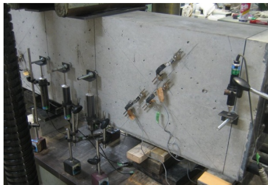
写真-2 载荷および計測状況写真
