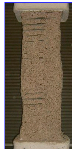
流し込み成形: F_c=85\text{N/mm}^2
