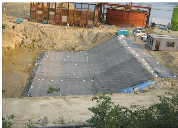
漏水検知システムの原理および実験全景(海水注入前)
