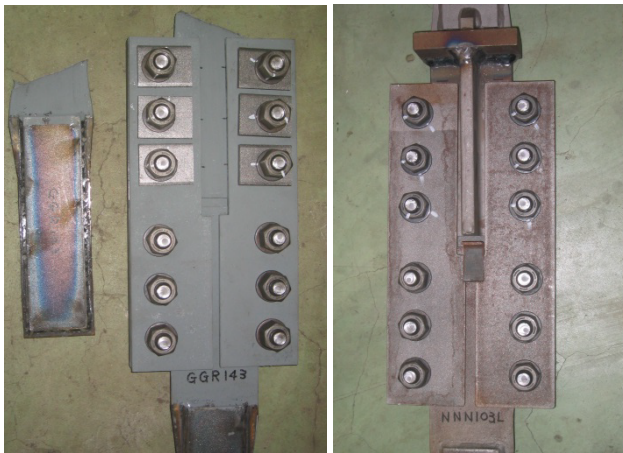
試験体 GGR143 (中板が破断)
