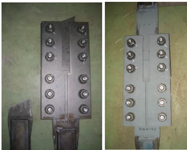
試験体 NNN103 (中板が破断)
