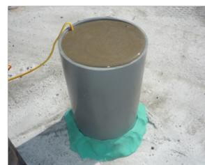
写真-4 超速硬モルタル充填(試験体1)
