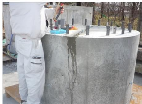
写真-2 破砕剤装薬(試験体1)
