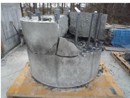
写真-13 破砕状況(試験体3:一部撤去)
