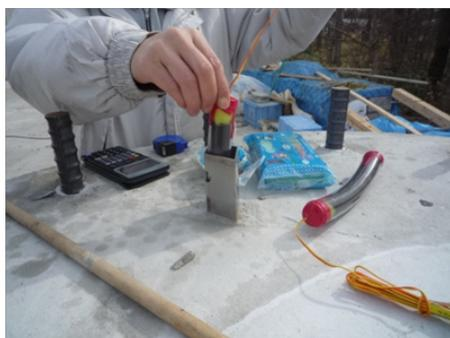
写真-12 破砕剤装薬(試験体3)
