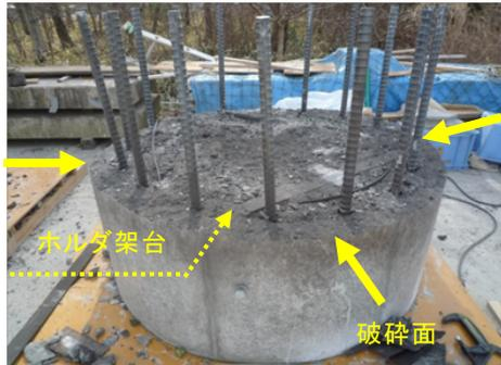
写真-7 杭頭天端状態(試験体1:上部除去後)
