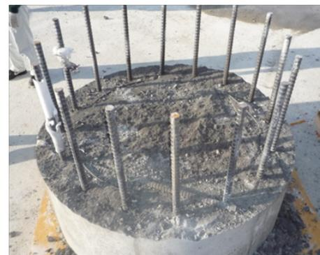
写真-11 破砕面状況(試験体2)
