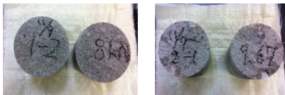
破壊界面の状態（左：ケース1，右：ケース2）
