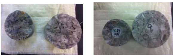
破壊界面の状態（左：ケース3，右：ケース7）
