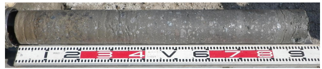
写真-3 ゲルプッシュサンプルングでの採取試料 (表面に光って見えるのが切断されたスラグ粒子)
