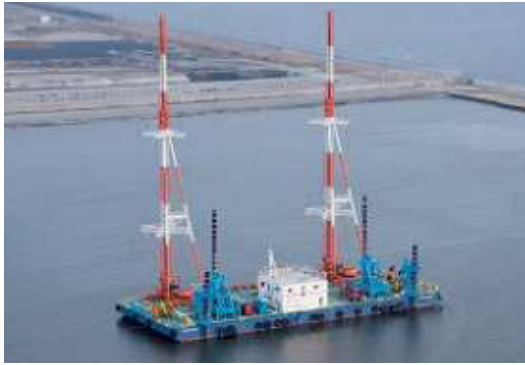
写真-2 ドレーン打設船「VCD-Triton」
