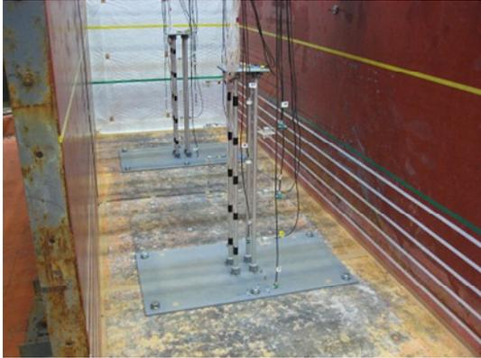
写真-1 杭基礎設置状況 (錘設置前)
