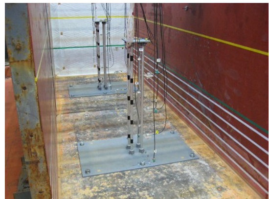
写真-1 杭基礎設置状況（錘設置前）
