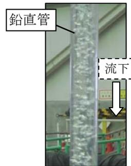
図-8 鉛直管内で形成された気液二相流
