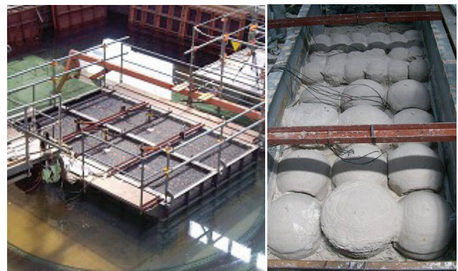
写真-1 模型振動台実験の全景 (左) 改良体の出来形例 Case4 (右)
