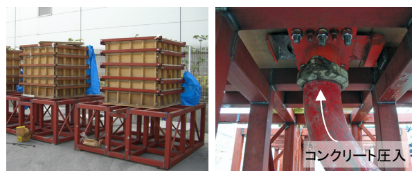
図-2 圧入試験体 (上左: 水平断面図、上右: 鉛直断面図) (下左: 設置状況写真、下右: 試験体下部)
