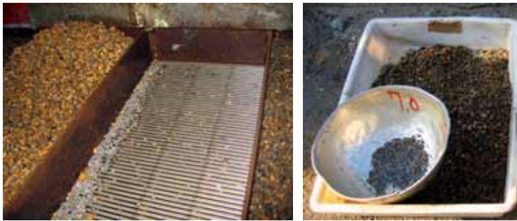
写真-6 分離状況(左)・除去後土壌および鉛散弾(右)
