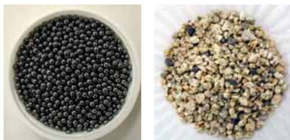
写真-2 鉛散弾（左）および模擬汚染土壌（右）
