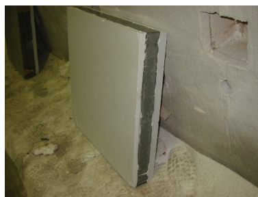
写真-1 要素実験2試験体(ケイカル板 t=15)
