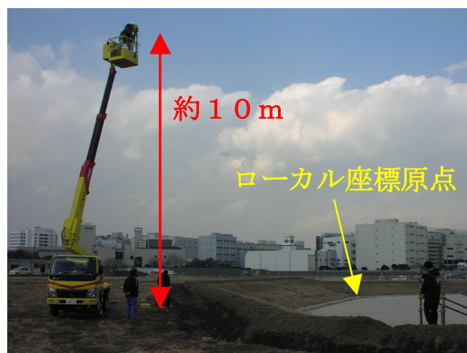
写真-10 平和島人工海浜ノンプリズムレーザ式 TS 配置
