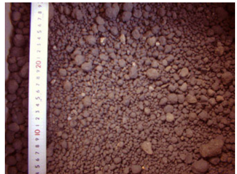
主灰 100:浚渫土 80:還元剤 10
