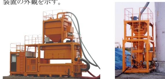
写真-2 比重調整装置 写真-3 粉体供給装置
