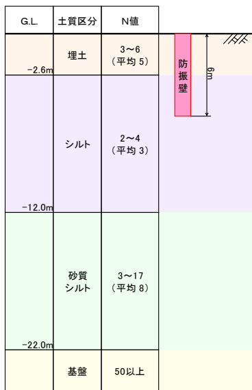
図-1 地盤概要とドレーン打設深度
