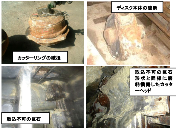
写真-5 ディスクカッター、カッターヘッドの破損状況
