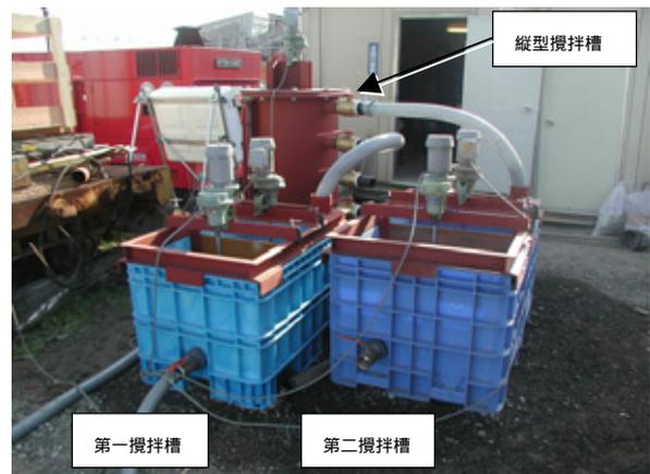
写真 - 3 凝集反応装置
