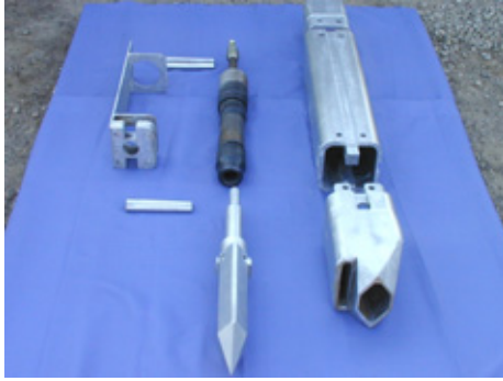
写真 - 3 先端ブレード分解状況
