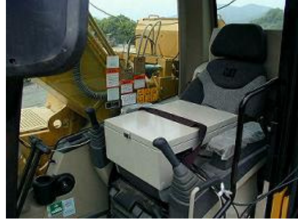
写真 - 4 バックホウへの機器収納箱の設置状況
