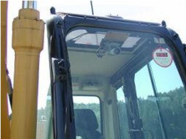
写真 - 2 バックホウ車載カメラ状況
