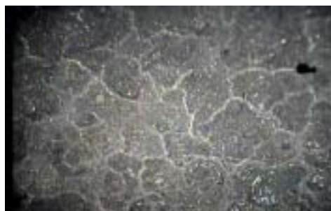
写真 4 複合劣化後の塗装表面 200倍(ETs:200倍)
