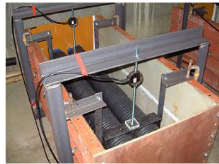
写真 - 3 浮力測定実験型枠(例 130mm 埋設時)
