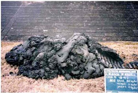
写真 - 2 改良土 (固化材のみ)
