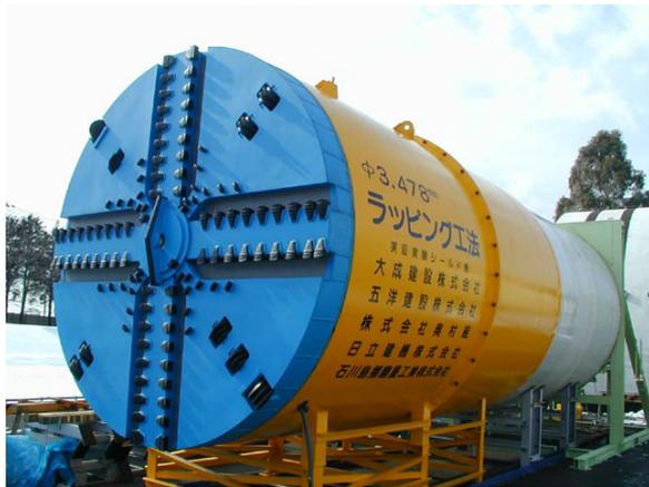
写真 - 1 実証実験シールド機
