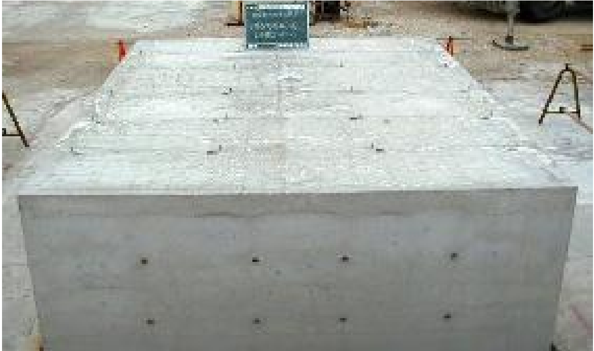
写真 - 3 試験施工充填状況（球陽生コン）
