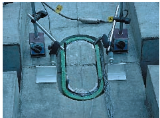
写真-1 締結材の設置状況（実験時）
