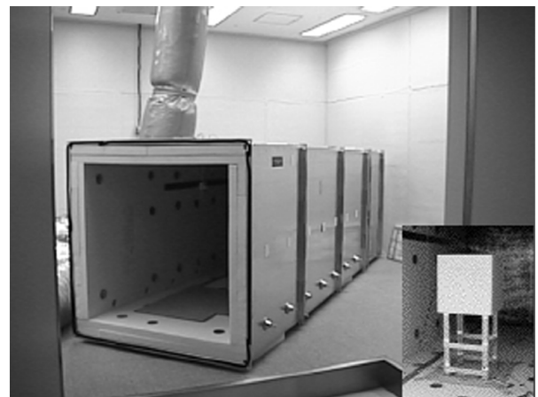
写真-1 小型風洞装置外観および供試体（右下）
