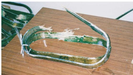
写真-7 セグメント締結材破断状況
