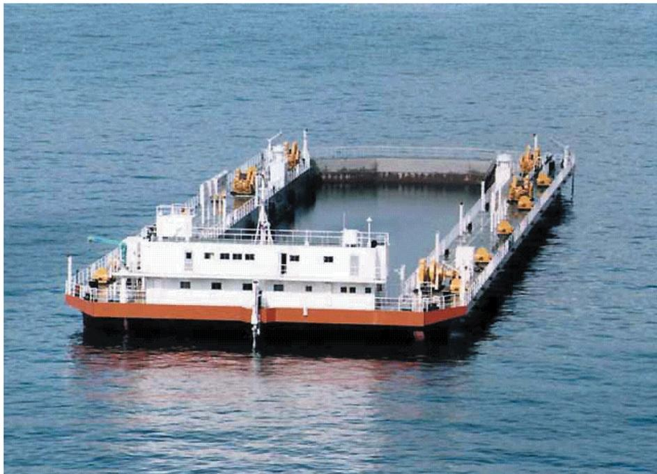
写真 - 1 汚濁防止枠船（沈降時）
