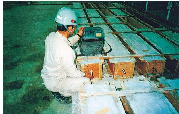
写真-1 ロックボルト長さ測定器
