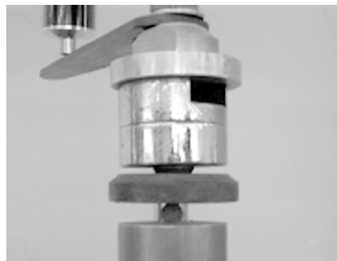
写真 - 3 造粒物の圧潰試験
