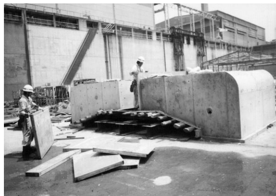
写真-2 ハンチ部実物大模型
