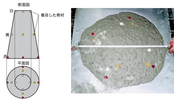
写真 - 1 スランプフロー試験における粗骨材の動き
