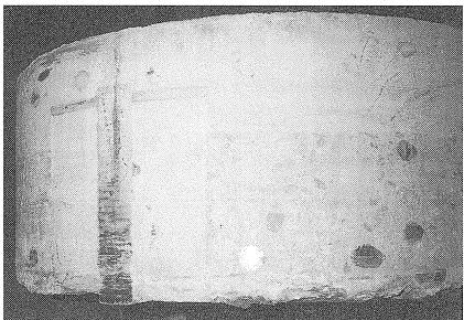
写真-11 コア抜きした被削材の表面
