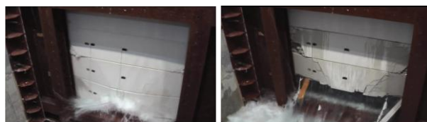
写真-3 破壊時以降の状況(横張・正圧)
