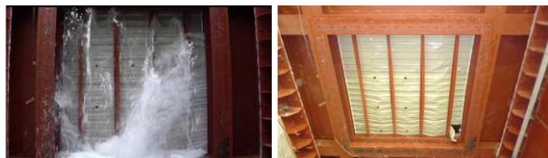
(a) 座屈発生時 (b) 終了時 写真-7 座屈発生時以降の状況(横張・正圧)
