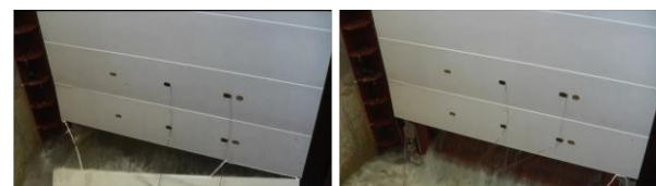
写真-4 破壊時以降の状況(横張・負圧)
