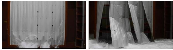
(a) 座屈発生時 (b) 破壊直後 写真-6 座屈発生時以降の状況(縦張・負圧)
