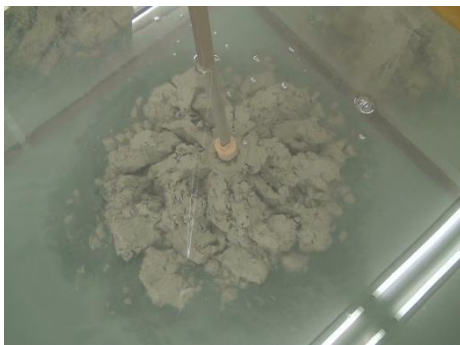
写真-1 処理土A打設直後
